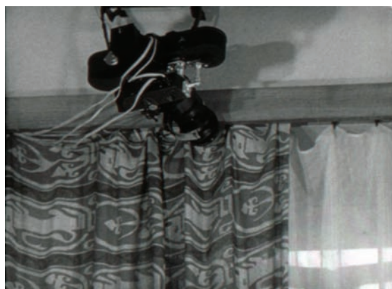
Aparat Pentacon Super przystosowany do seryjnego fotografowania z punktu zakrytego. Kadry z filmu instruktażowego „Pentacon Super”
