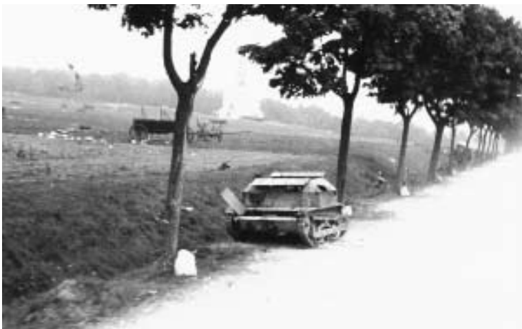
Uszkodzona i pozostawiona tankietka TKS
